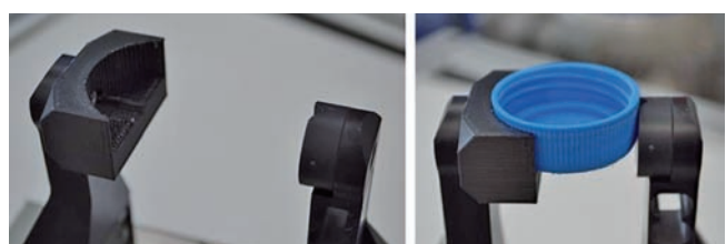
Obr. 5 Vľavo na obrázkoch je upravený tvar prstov chápadla, vpravo ich pôvodný tvar.
