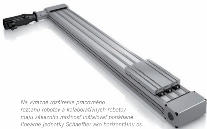
Kompaktná lineárna os firmy Schaeffler sa skladá z tandemového modulu MDKUBE, príslušnej jednotky motora/prevodovky, prefabrikovaných káblov motora, ťažnej reťaze pre všetky zásobovacie vedenia kobota a riadiacej jednotky motora. Dlhšie lineárne osi sú vytvorené ako viacdielne lineárne moduly, vďaka čomu možno realizovať dráhu pojazdu kobota v dĺžke až 18 metrov.
