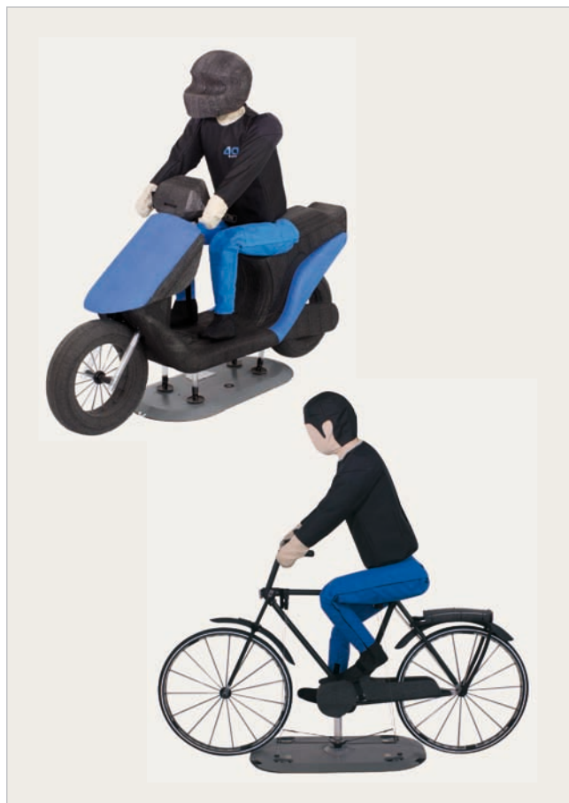
Existujúce pasívne opatrenia sú posilnené aktívnou ochranou chodcov. V systéme 4activeSystems sa na testovanie systémov predchádzania kolíziám používajú realistické figuríny.
