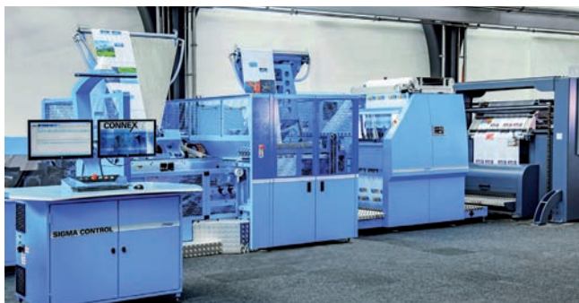
Výrobná linka SigmaLine využívajúca systém Connex LineControl na správu dát a procesov umožňuje efektívnu kusovú výrobu kníh.
